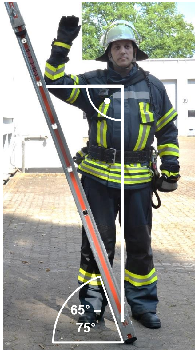
Abbildung 2: Überprüfen des Anstellwinkels
