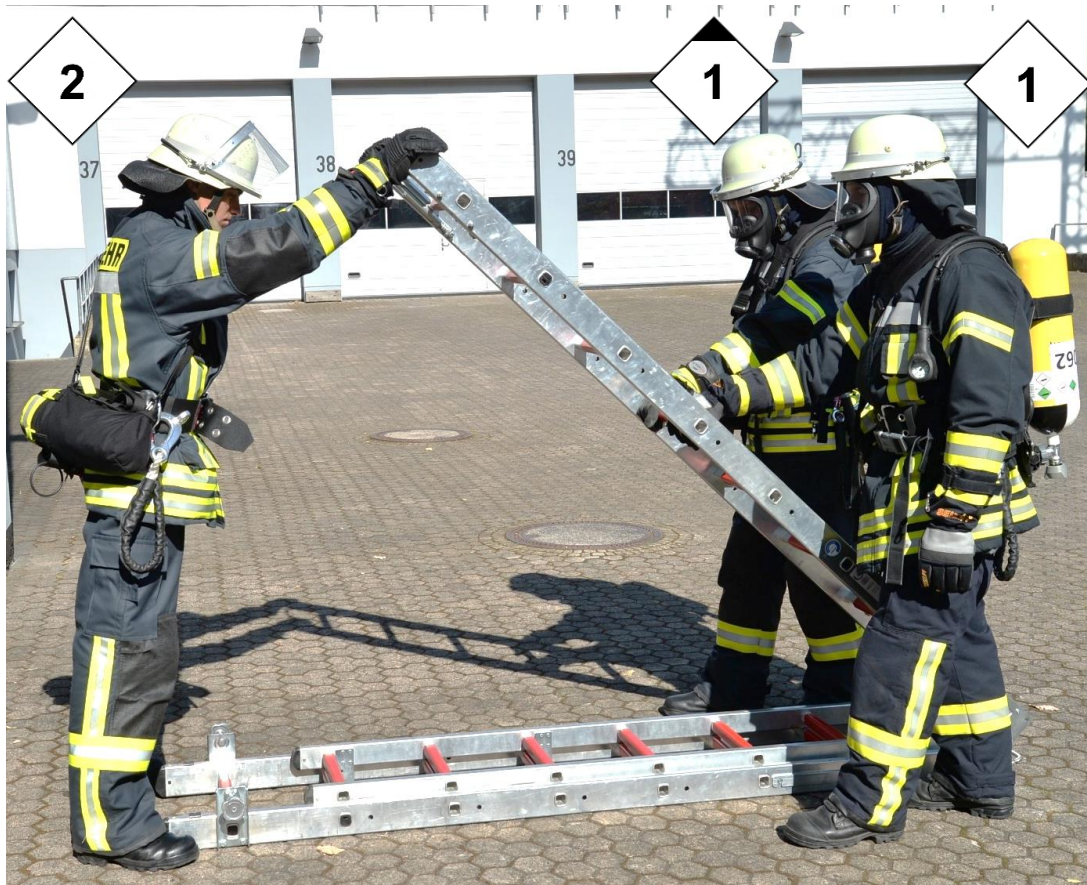
Abbildung 32: Aufklappen der Multifunktionsleiter
