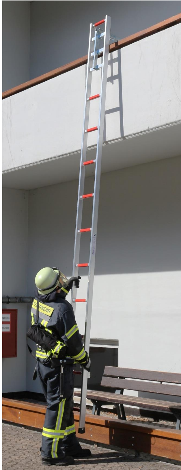
Abbildung 27: Einhängen der Hakenleiter
